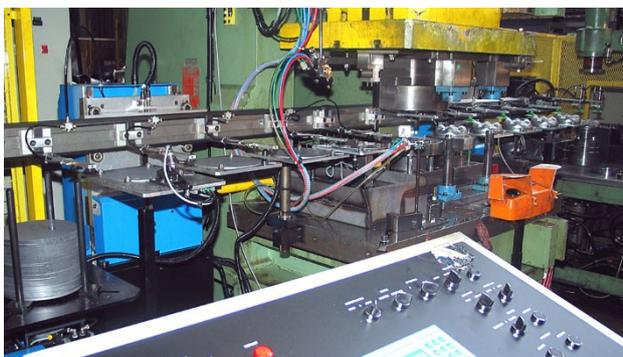
Amidec fabrique toute un gamme de transferts monobarre, avec distribution des flans par magasin, bol vibrant, amenage, etc.
