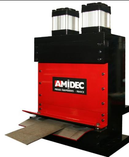
Spécialement conçue par Amidec pour couper la tôle en sortie d'outil de presse ou, couper les déchets.
